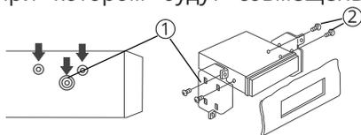
Для этого используйте либо крепежные винты (5 x 6 мм), либо винты с потайной головкой (4 x 6 мм), в зависимости от типа резьбовых отверстий на кронштейне.
